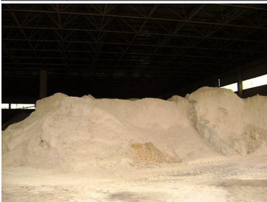
脱硫石膏存放点
